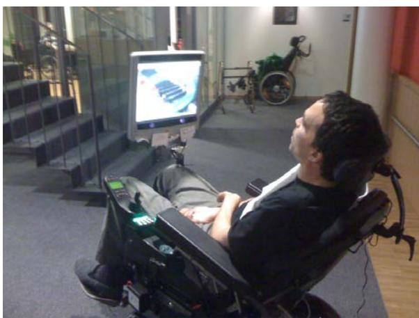
Das Augensteuerungssystem des Computers wird mittels angepasster Fixierung direkt am Rollstuhl angebracht. Sie wird durch einen Arm verlängert, womit das System stets den idealen Abstand zwischen 40 und 80 cm aufweist. Die Rückseite des Bildschirms ist mit einer Webcam ausgestattet. Sie ermöglicht, das Sichtfeld des Benutzers nach vorne durch den Bildschirm aufzuzeigen; dieser ist demnach transparent.
